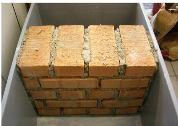
Abb. 4.24 und 4.25: Im Labor errichtete Bauteile aus NF-Vollziegelmauerwerk und Hohlblockziegeln
