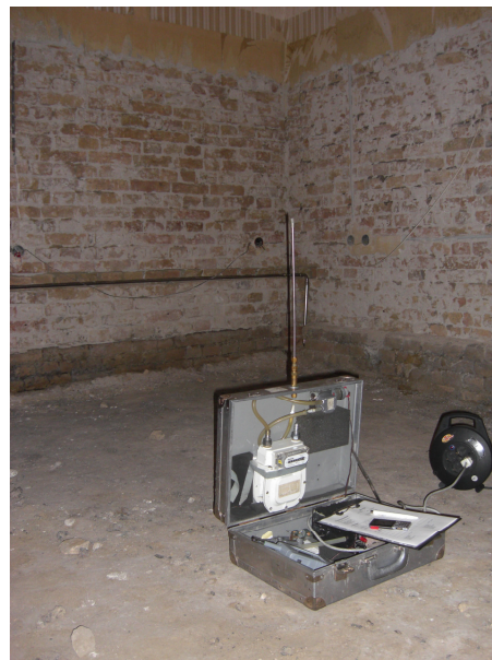
Abb. 3.2: Aufgebautes Probenahmegerät zur Messung von VOC in einem ehemaligen Schlafraum
