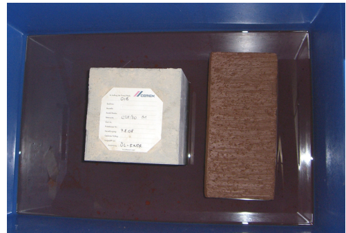
Abb. 4.2: In Öl gelagerter Betonprüfkörper und NF-Ziegel
