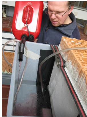
Abb. 4.26-4.28: Befüllen des Probebehälters mit Wasser bzw. Heizöl
