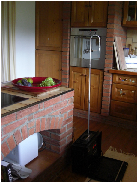
Abb. 3.1: Aufgebautes Probenahmegerät zur Messung von VOC (flüchtige organische Verbindungen) in einer Küche
