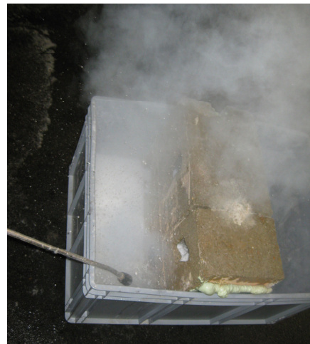
Abb. 4.34: Reinigung eines Prüfkörpers aus Kiesbeton-Hohlblockziegeln unter Hochdruck
