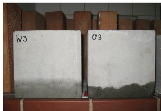
Abb. 4.16: Betonprüfkörper nach Wasser- bzw. Öllagerung (rechts)
