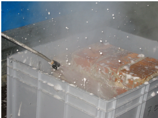
Abb. 4.33: Reinigung eines Prüfkörpers aus NF-Ziegeln unter Hochdruck
