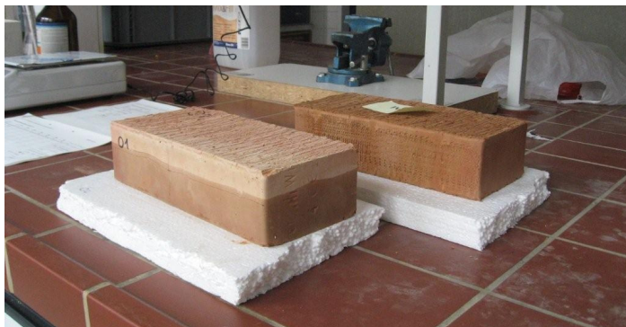
Abb. 4.3: NF-Ziegel nach Lagerung in Heizöl (links) und Wasser (rechts)
